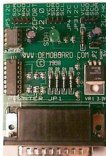
Il protocollo I2C si utilizza molto per la comunicazione di microcontroller con le loro periferiche. Con un circuito stampato come quello della figura si può dotare di una porta I2C la nostra installazione.
