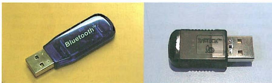
Utilizzando dei semplici connettori per USB come quelli dell'immagine possiamo dotare il nostro computer di una porta per trasmissione senza fili mediante il protocollo IrDA o Bluetooth.
