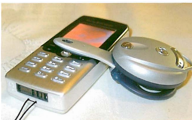
Auricolare Bluetooth di Motorola. Una delle applicazioni più richieste del sistema Bluetooth permette di comunicare con il nostro cellulare a mani libere e senza fili.
