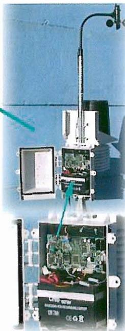
Stazione meteorologica controllata via GSM.
