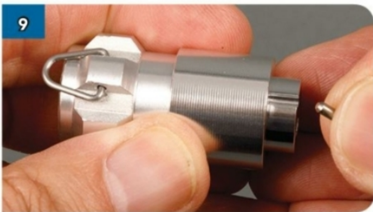
9 Incolla il secondo perno all'interno di DF-89, come nel passaggio 2.
