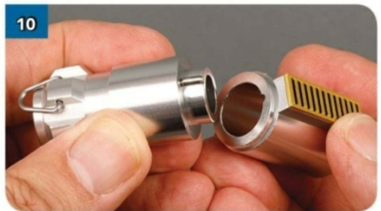
10 Monta DF-90 sopra DF-89, allineando il vano di DF-90 con il perno di DF-89. Applica qualche goccia di colla per fissare il pezzo.
