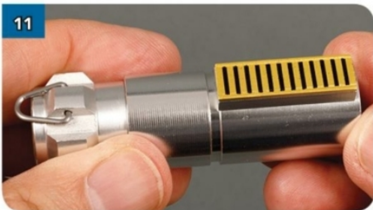
11 Unisci i pezzi tra loro, fino in fondo, prima che la colla si secchi.
