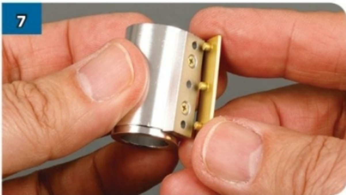
7 Inserisci i tre perni di DF-95 nei fori su DF-94 dopo aver applicato qualche goccia di colla per fissare permanentemente il tutto.
