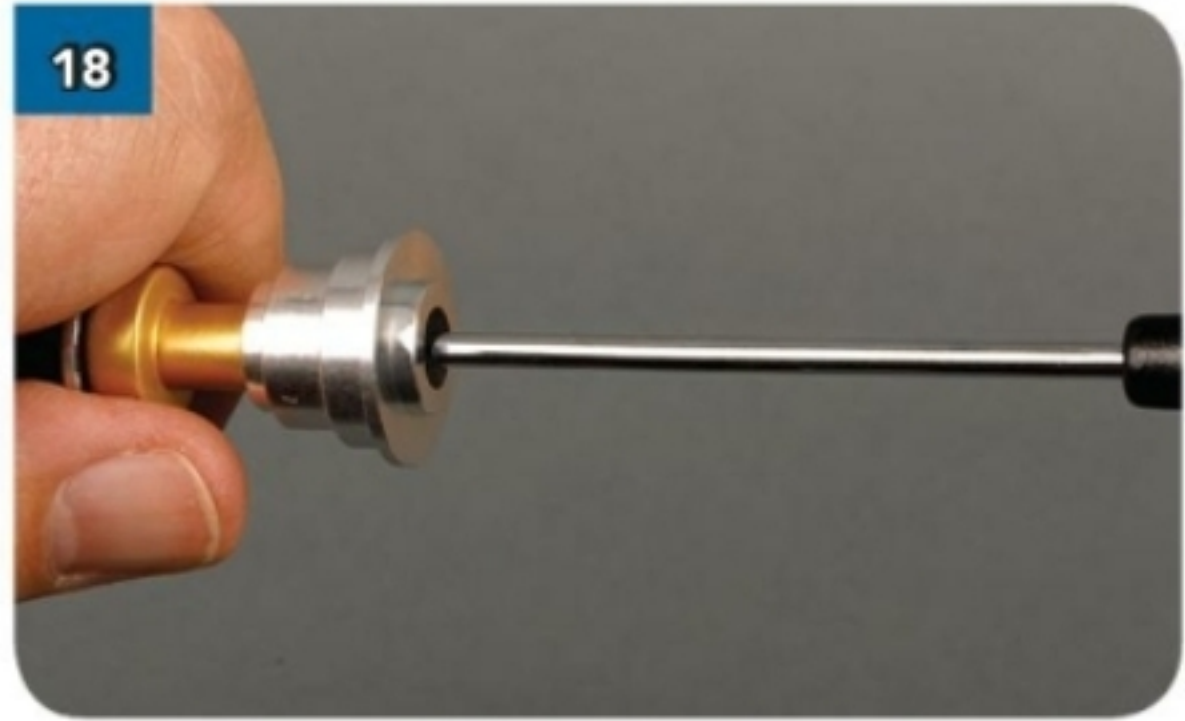
Fissa tra loro i componenti avvitando la vite di fermo.
