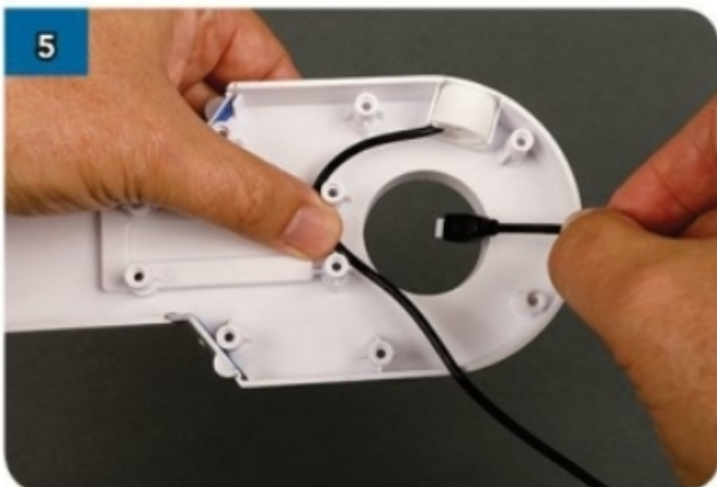
Fai passare il cavo del sensore attraverso l'ampia cavità al centro della placca.
