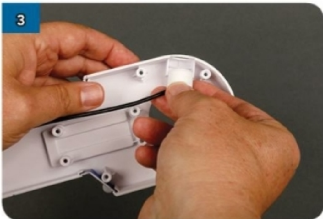
Inserisci il sensore dall'interno nell'apertura laterale della placca centrale esterna, assicurandoti che si inserisca correttamente.
