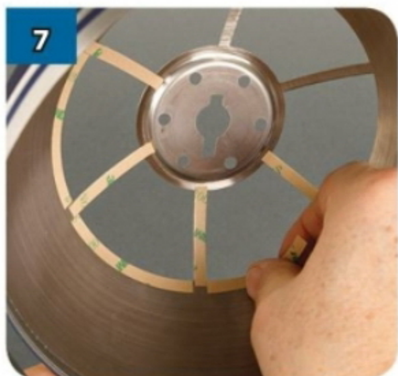
Attacca le strisce biadesive ricurve sui tre bordi della cupola compresi tra le strisce diritte attaccate nel passaggio precedente.
