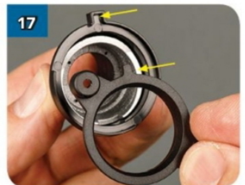
17 ... e la linguetta nella parte superiore si inserisca nell'alloggiamento corrispondente nel perno del proiettore.
