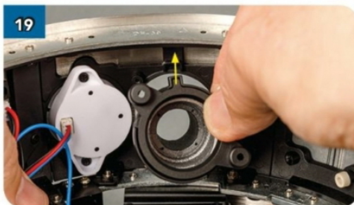
19 Monta il pezzo nel telaio, in modo che la linguetta del passaggio 17 si inserisca nell'incavo indicato dalla freccia.
