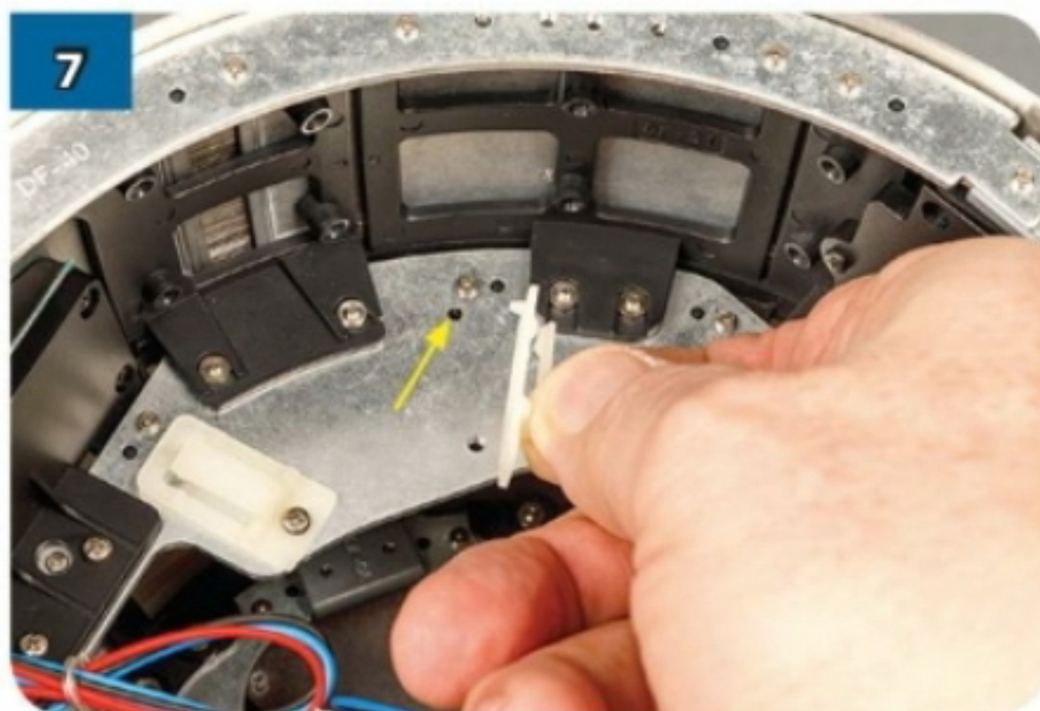
7 Inserisci qui il terzo fermacavi, esattamente come prima... ... e fissalo con una vite.
