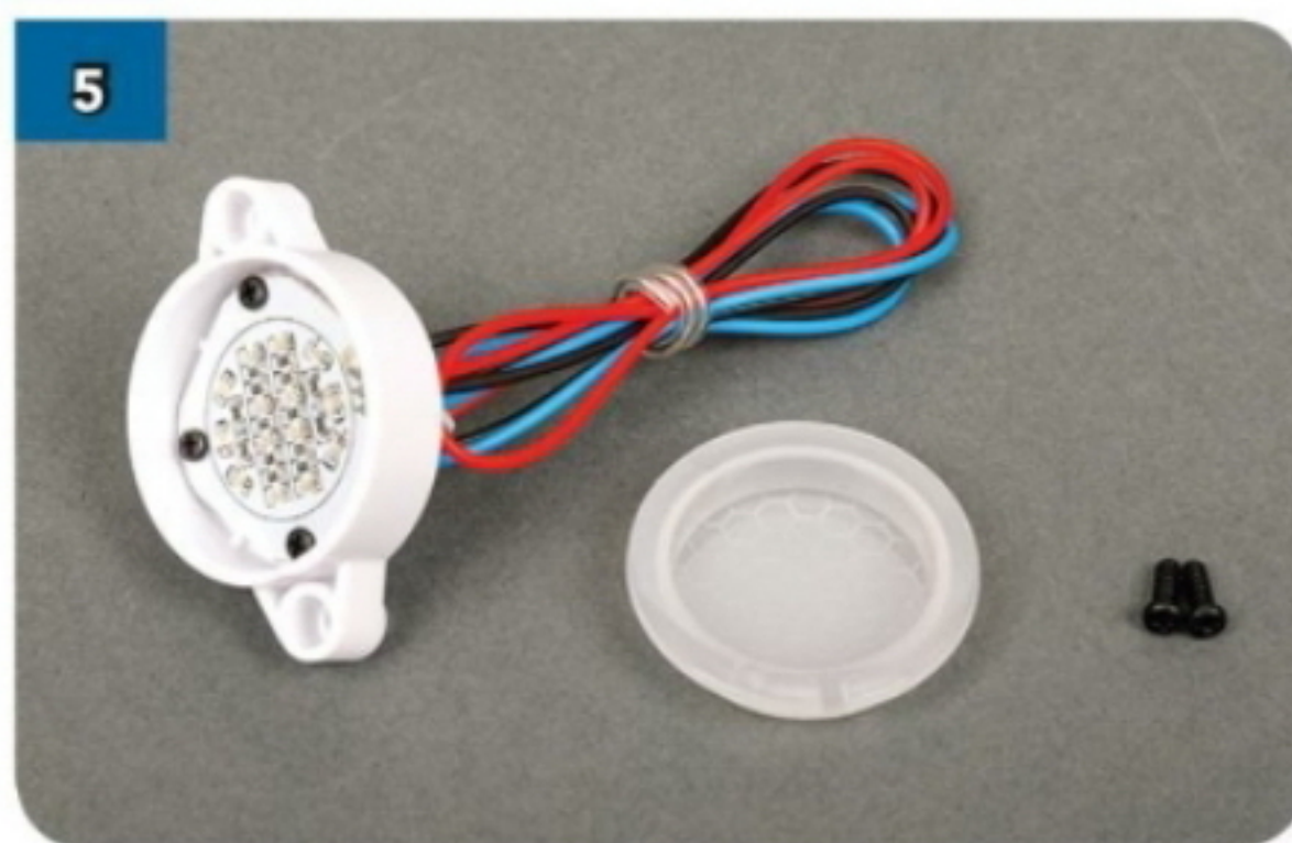
5 Prendi l'indicatore di stato del processore dalla Fase 45, la lente fornita in questa uscita e due viti autofilettanti da 2,3x6 mm.
