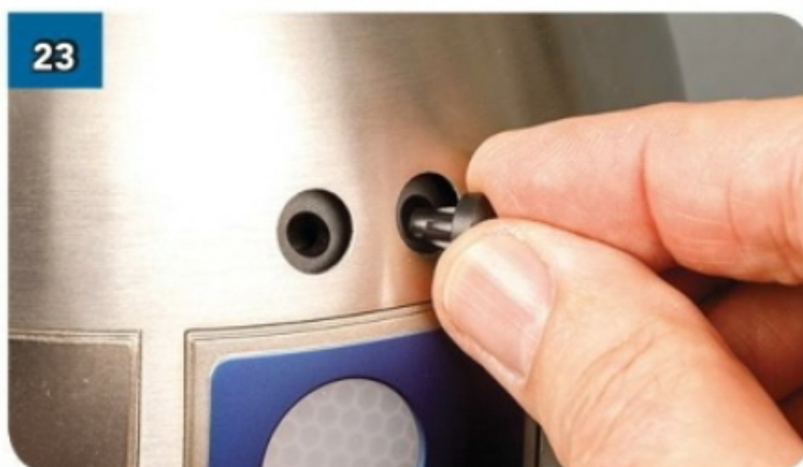
23 ... e spingi il primo dettaglio in uno dei fori sopra la lente dell'indicatore di stato del processore.
