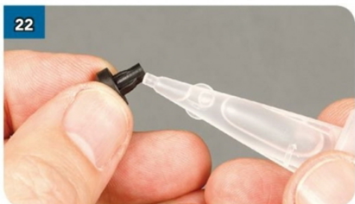
22 Applica con attenzione qualche goccia di supercolla intorno alla punta dei dettagli, evitando di sporcarti le dita...
