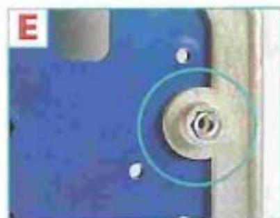
**E** Al foro 8 corrisponde, sul lato superiore del telaio, la guida del dado.
