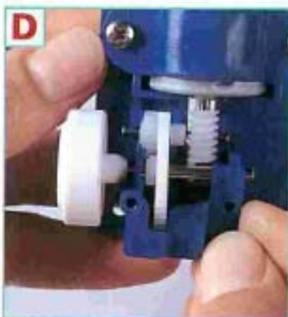
**D** Posiziona la grappa ferma ingranaggio, con l'incavo più profondo in corrispondenza della ruota dentata. **E** Avvita quindi le due viti autofilettanti di 13x2,2 mm.
