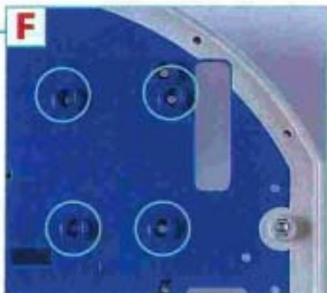
**G** Posiziona il blocco motore sul lato inferiore del telaio, nella sede 1, e avvitalo con le viti e i dadi M3.
