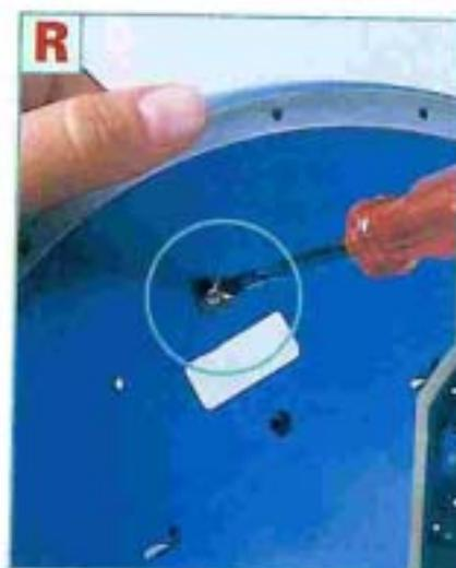
**R+S** Tenendo ferma la forcella, sovrapponi al foro (sul lato superiore del telaio) la rondella e avvita infine la vite autofilettante 10x2,5 mm.
