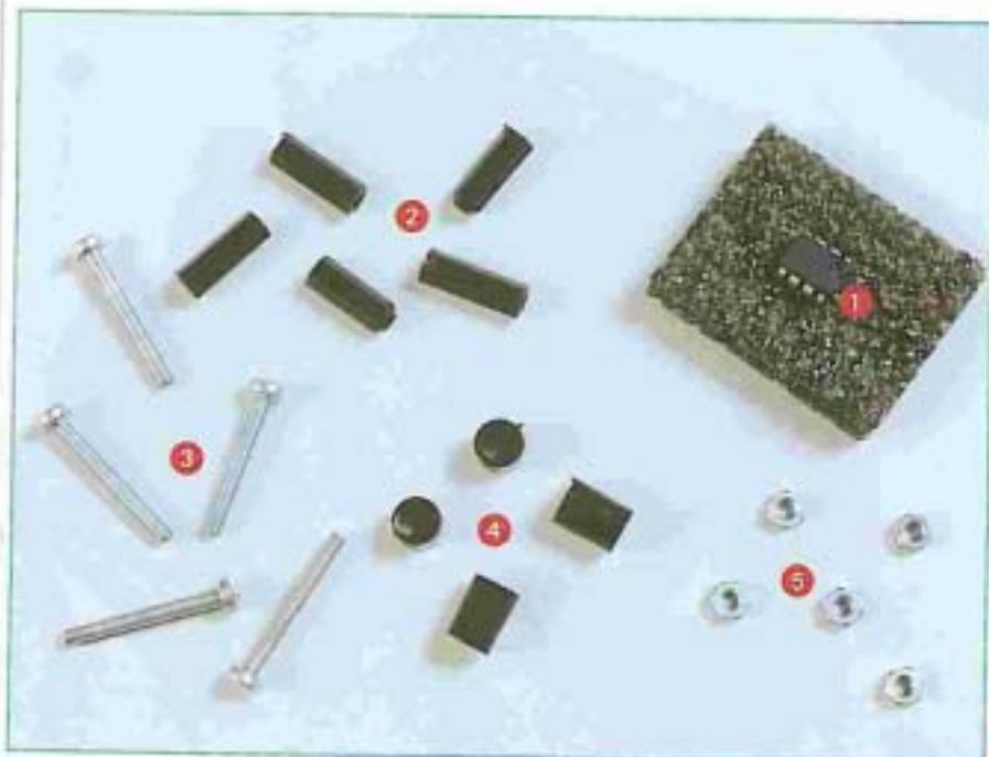
Oltre al chip della memoria, in questo fascicolo ti sono forniti gli elementi necessari al montaggio della scheda madre sul telaio del robot. Per questa operazione, in realtà, ti occorrono solo quattro dei cinque distanziali allegati. Il quinto, che in questa fase monterai sulla scheda madre, ti servirà in seguito, per fissare su di essa la scheda di controllo motori. Anche i cilindri cavi saranno utilizzati solo più avanti, per rivestire i LED emettitori dei sensori a infrarossi.
