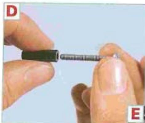
**D** Per prima cosa, è opportuno montare il distanziale per la scheda di controllo motori, allo scopo di non perderlo e di averlo a disposizione per le fasi di montaggio previste nel prossimo fascicolo. Inserisci una delle viti nel distanziale più lungo (17 mm).
