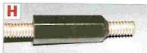
**H** I distanziali con l' estremità arrotondata vanno montati nei fori ① e ② della scheda madre, cosicché, quando questa sarà fissata al telaio, si inseriscano nella parte concava del paraurti. Inserisci la vite in modo che la parte smussata del distanziale sia orientata in direzione opposta alla testa della vite.
