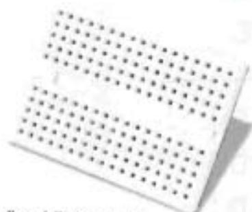
La breadboard, allegata a questo fascicolo, costituisce di fatto una piattaforma di sperimentazione per la realizzazione di circuiti elettronici in grado di interfacciarsi con il microcontrollore del tuo robot.
