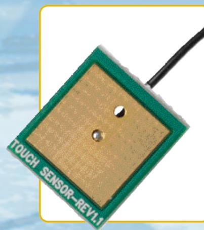
◀ Un dettaglio del sensore di contatto. Potrai utilizzarlo insieme alla scheda MR-C3024 per creare dei programmi in RoboBasic che sfruttano il suo funzionamento.
