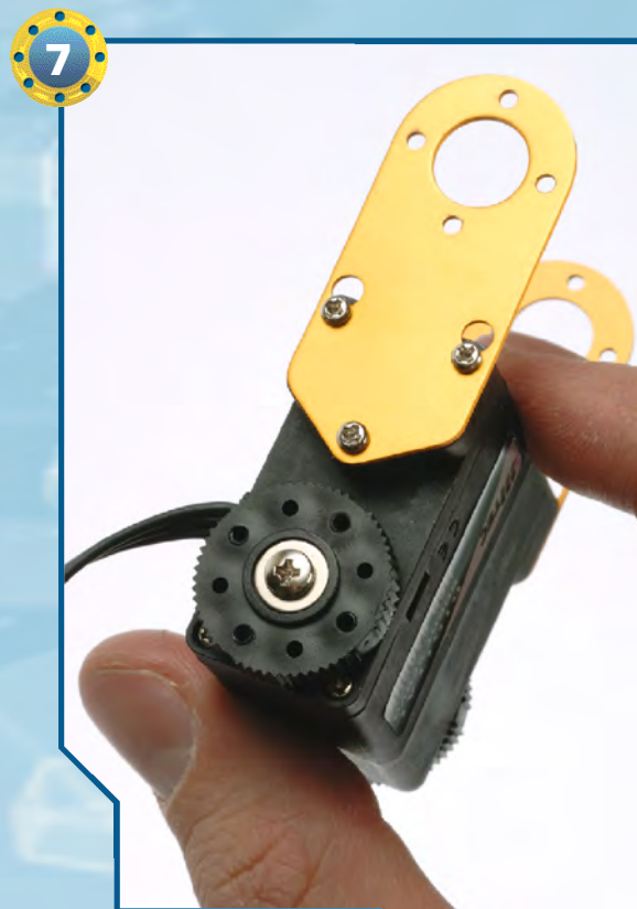
◀7▶ Fissiamo la squadretta al servo, serrando le due viti di tipo T-2 da 2x18 mm e reinserendo la vite di tipo T-2 da 2x5 mm rimossa in precedenza.
