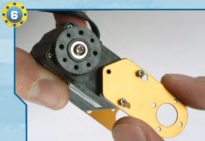
◀6▶ Posizioniamo una squadretta a L anche su questo lato del servo, come mostrato nella foto.
