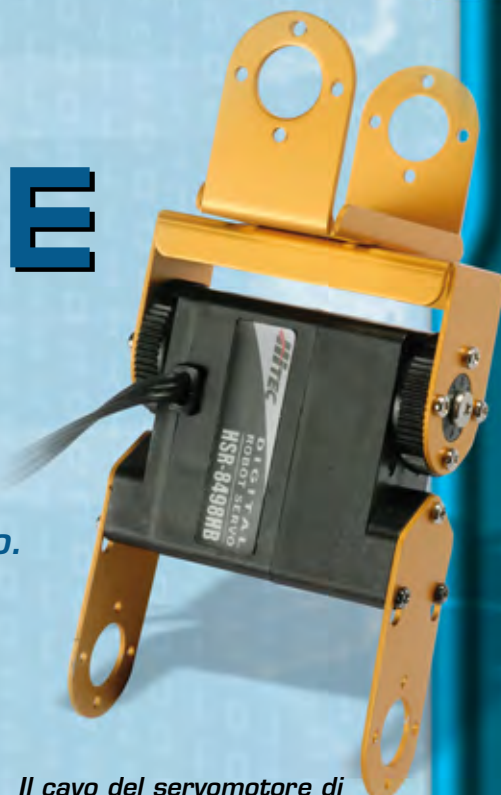
Il cavo del servomotore di tipo A montato nella zampa posteriore sinistra esce dal lato destro del motore.
