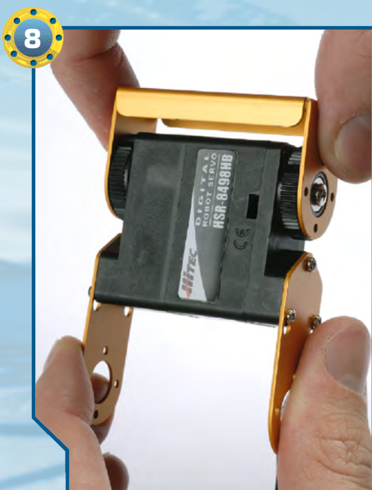
◀8▶ Prendiamo una squadretta metallica a U (con 22 fori) e incastriamola sul servomotore, come illustrato nell'immagine.
