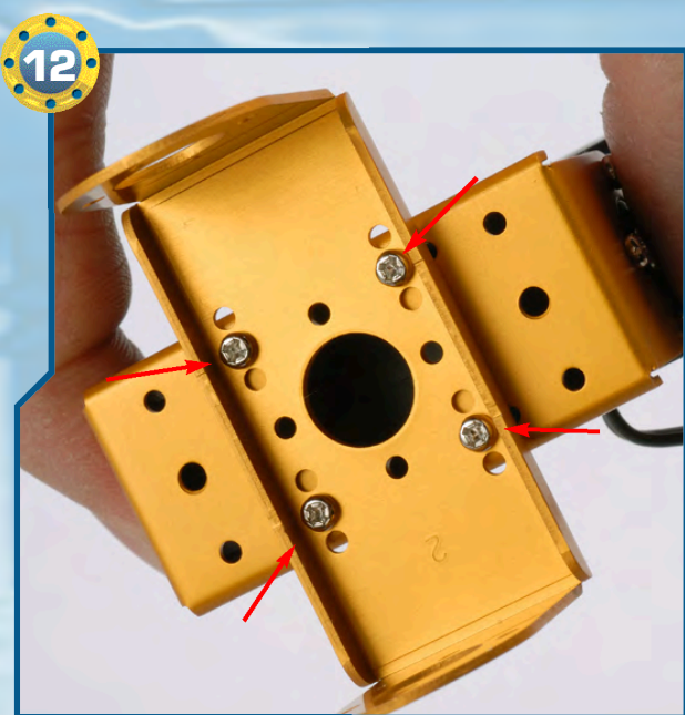
12 Fissiamo le due squadrette con quattro viti di tipo M da 2x4 mm, serrandole nelle posizioni indicate dalle frecce.
