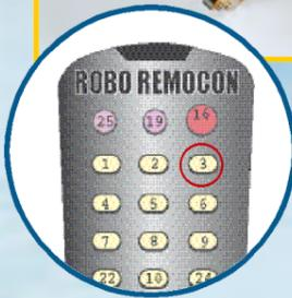
La pressione del tasto '3' fa ruotare RoboSpider di circa 30 gradi in direzione antioraria.
