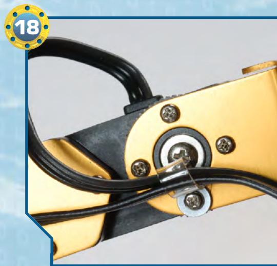
◀18▶ Serriamo quattro viti di tipo T-2 da 2x4 mm per fissare la squadretta circolare di tipo 4 del servo alla squadretta di metallo. Come al solito, utilizziamo una delle viti per fissare il cavo dei due servomotori, servendoci di una fascetta trasparente e di una rondella.
