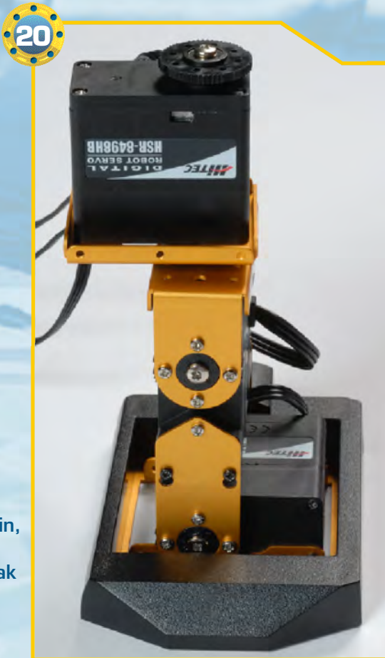
◀19▶ Fissiamo anche l'altro lato del servo, per mezzo di quattro viti di tipo T-2 da 2x4 mm.
