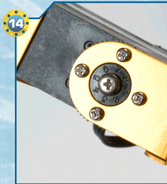
◀14▶ Orientiamo le tacche della squadretta circolare di tipo 3 come nell'immagine, quindi fissiamola con quattro viti di tipo T-2 da 2x4 mm.
