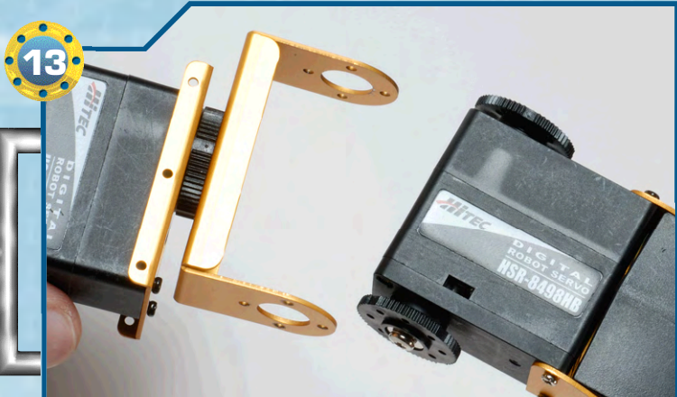
◀13▶ Uniamo i due elementi appena assemblati, inserendo il servomotore di tipo B nella squadretta metallica a U.
