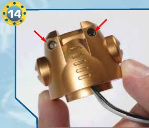
▶14▶ Prendiamo la testa di RoboZak e rimuoviamo le due viti indicate dalle frecce.
