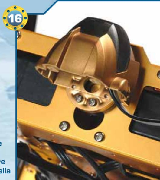
▶16▶ Serriamo due viti di tipo T-2 da 2x8 mm per fissare la testa al resto della struttura.
