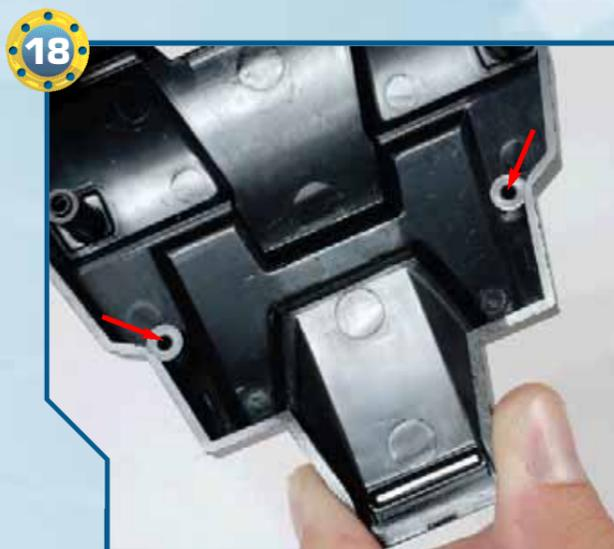
▶18▶Prendiamo l'armatura del torace: i due fori indicati dalle frecce ci serviranno per fissarla all'intelaiatura metallica frontale tramite due viti di tipo T-2 da 2x4 mm.
