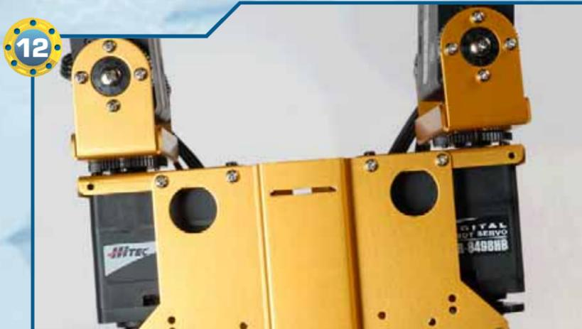
▶**12**▶ Fissiamo le due zampe anche alla parte frontale di RoboPenguin, utilizzando quattro viti di tipo M da 2x4 mm.
