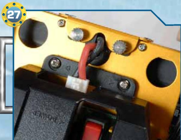
▶27▶ Inseriamo il pacco batterie tra le due intelaiature metalliche e colleghiamolo alla scheda di controllo. Quindi posizioniamo la flangia del coperchio nella rispettiva fessura dell'intelaiatura del torace e fissiamola serrando i due bulloni da 3x4 mm.
