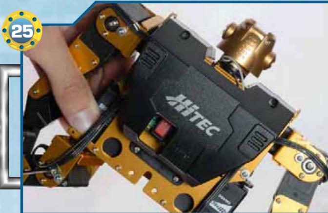
▶25▶ Posizioniamo l'armatura in plastica del dorso, facendo attenzione a non schiacciare i cavi dei servomotori e a non danneggiarli. Fissiamo quindi l'armatura con una coppia di viti di tipo T-2 da 2x26 mm (in alto) e una coppia di viti di tipo M da 2,6x4 mm.
