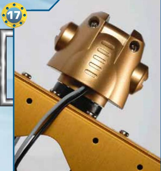
▶17▶Richiudiamo la testa del robot, riposizionando la parte posteriore e serrando le due viti di tipo T-2 da 2x5 mm rimosse in precedenza.
