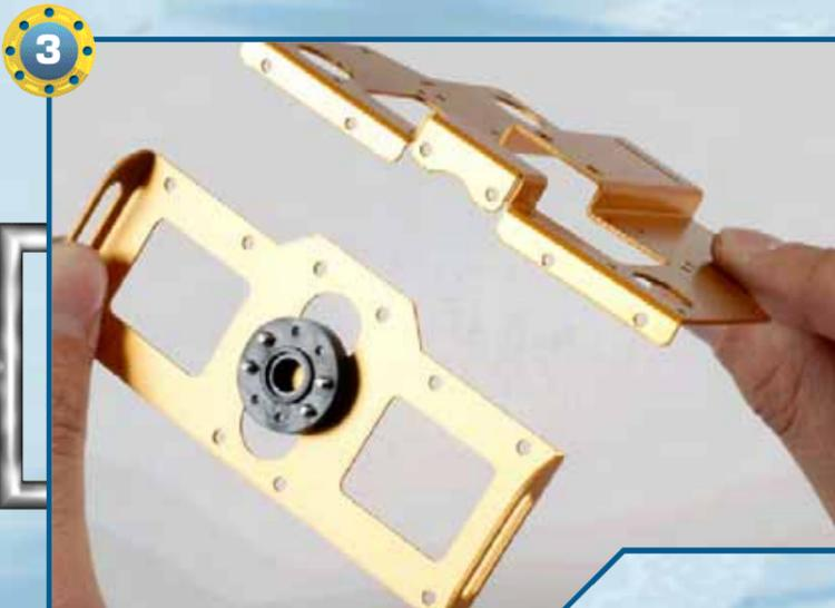
▶3▶ Prendiamo l'intelaiatura metallica del torace e, orientandola come nell'immagine, accostiamola all'intelaiatura metallica superiore.
