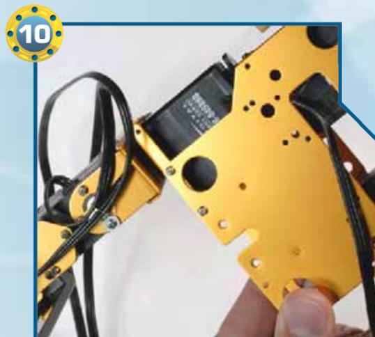
◀**10**▶ Uniamo ora al tronco la zampa sinistra, serrando due viti di tipo M da 2x4 mm. Il cavo del servomotore di tipo B presente sulla parte superiore della zampa deve fuoriuscire dalla finestrella presente sulla piastra metallica.
