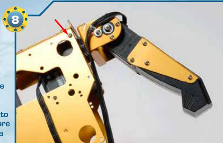
►8► Ripetiamo l'operazione effettuata al passo precedente collocando l'ala destra e fissandola con una vite di tipo M da 2x4 mm. Anche in questo caso ricordiamoci di far passare il cavo del servo di tipo C dalla finestrella presente sul dorso.
