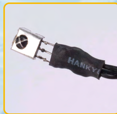
Un dettaglio del ricevitore IR, con cui sarà possibile comandare RoboZak per mezzo dello speciale telecomando Remocon.
