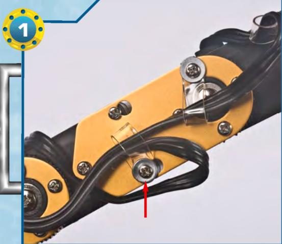
1 Iniziamo con il rimuovere la vite di tipo T-2 da 2x18 mm (indicata dalla freccia) dal servomotore centrale del braccio destro (il servomotore collegato al connettore C2).
