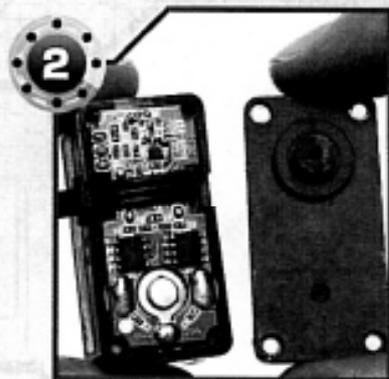
◀2▶ Una volta posizionato correttamente il cavo elettrico, procediamo alla chiusura del servo posizionando il rivestimento inferiore, come è mostrato
