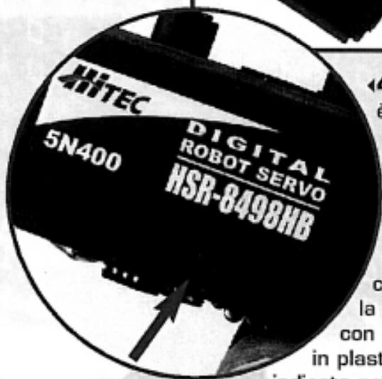
◀4▶ In queste due immagini è mostrato il motore con le due linguette di plastica rimosse. In questo modo, il cavo elettrico del motore può essere fatto passare attraverso una delle due fessure create e consentire la sua corretta chiusura con il rivestimento inferiore in plastica del servo, come indicato nelle istruzioni di montaggio.
