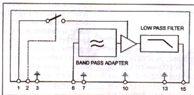
Figure 4 : Schéma synoptique du module hybride AUREL "MCA".
