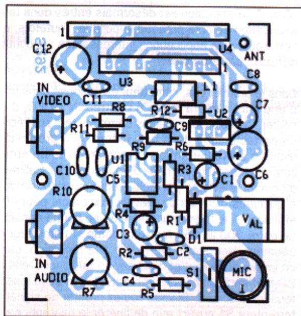
Figure 6 : Plan d'implantation des composants de l'émetteur audio/vidéo avec final à module hybride AUREL "MCA".
