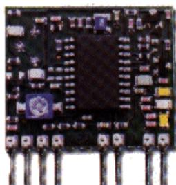
A l'intérieur, nous avons un double modulateur audio/vidéo qui agit sur un oscillateur très stable accordé sur 224,5 MHz, donc à la limite de la bande VHF (canal TV H2). Telle est la fréquence de la porteuse vidéo.
