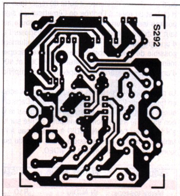
Figure 7 : Circuit imprimé à l'échelle 1/1 de la version du booster audio/vidéo VHF avec final à module hybride AUREL "MCA".
