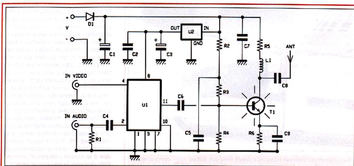
Figure 1 : Schéma électrique de l'émetteur audio/vidéo avec final à transistor.
