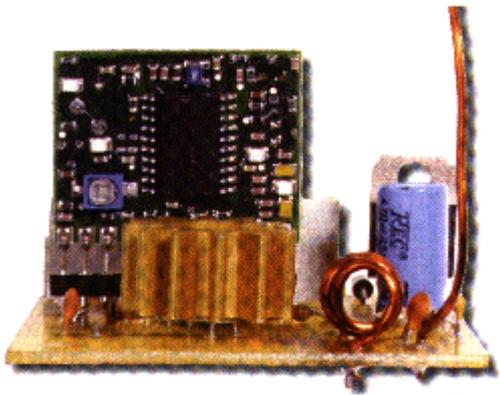
La première version de l'émetteur de puissance utilise un seul transistor haute fréquence pour l'amplification du signal VHF généré par le module hybride AUREL. Cette version est idéale pour les plus expérimentés d'entre-vous car elle peut être modifiée par l'utilisation, à des fins d'essais, de transistors de différentes puissances, par l'ajout de filtres passe-bas de sortie, etc. Mais il est également possible d'employer des modules VHF, puissants et faciles à utiliser.
