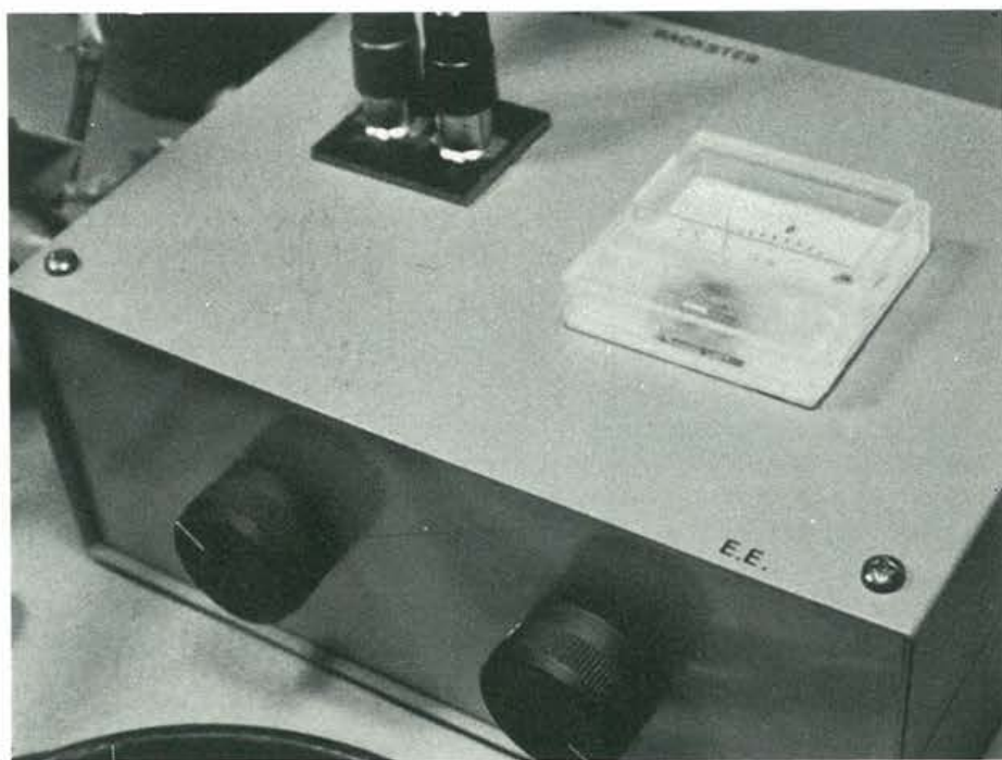
In alto, lo schema elettrico del dispositivo; i transistor T1 e T2 sono collegati rispettivamente ad uno dei due ingressi, ed i loro segnali sono trasferiti all'amplificatore operazionale U1. I risultati dei rilevamenti si leggono sulla scala di un milliamperometro.
