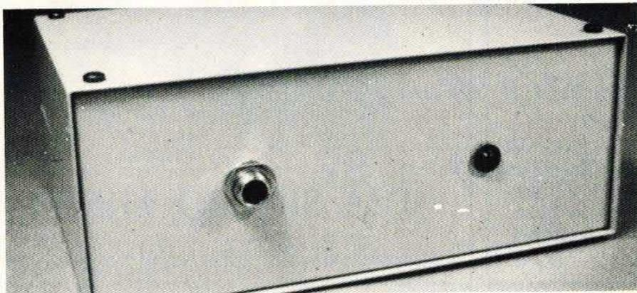
Trasmettitore a modulazione di frequenza sulla gamma 88-108 MHz con potenza di uscita di 2 Watt. Questo apparecchio, in unione all'alimentatore ed al mixer, consente a chiunque, con modica spesa, di installare una completa stazione FM la cui portante può raggiungere i 5 Km. L'emissione è caratterizzata dall'assenza di emissioni spurie e da una notevole fedeltà. L'apparecchio viene fornito completo di contenitore e di tutte le minuterie necessarie.
