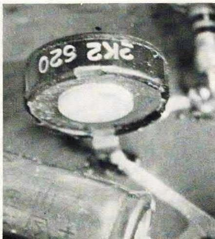
interposizione elettrica di un condensatore ceramico C7 avente la capacità di 1800 pF. Ciò per evitare di immettere nel circuito potenziali che potrebbero danneggiare l'integrato.
