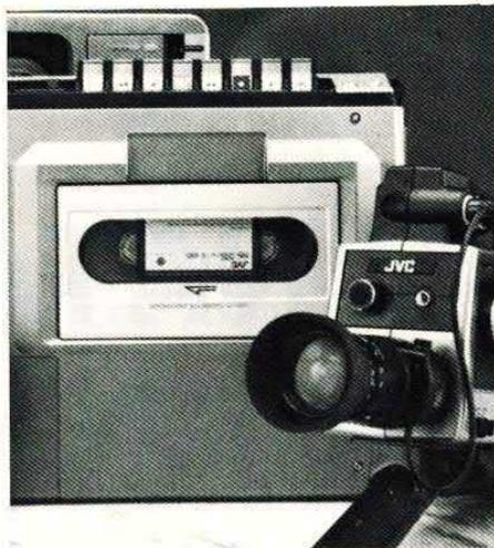
stema portatile della JVC che si compone di una telecamera GC-4100, di un video registratore HR-4100 e di un modulo di sintonia programmabile da applicare a qualsiasi televisore a colori con sistema PAL. Il registratore utilizza cassette video della durata di tre ore, il suo azionamento è semplicissimo ed è anche possibile applicare successivamente una base sonora alle immagini registrate.
