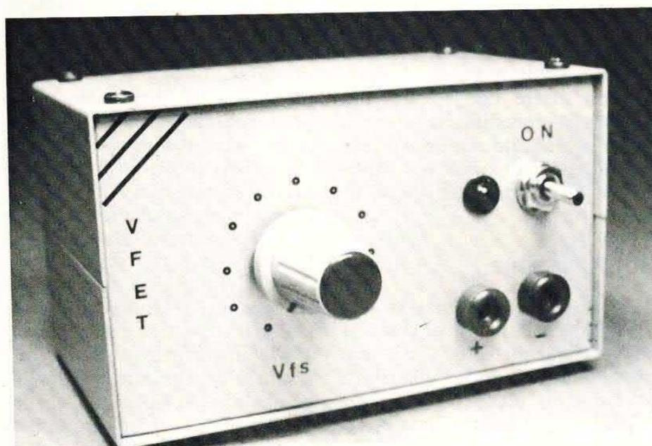
*Il circuito funziona secondo il principio dei circuiti a ponte. Come potete vedere dal disegno al centro, i lati di riferimento sono realizzati con due FET.*
