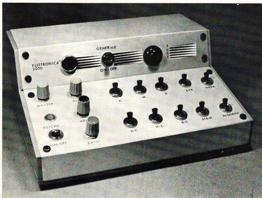
luzione sia necessaria anche se aumenta leggermente i costi. In tale stadio inoltre, nel calcolo delle capacità di accoppiamento e di quelle di compensazione, ci si è preoccupati di restringere la banda rispetto ai classici 20 Hz 20000 Hz che caratterizzano un amplificatore Hi-Fi.
