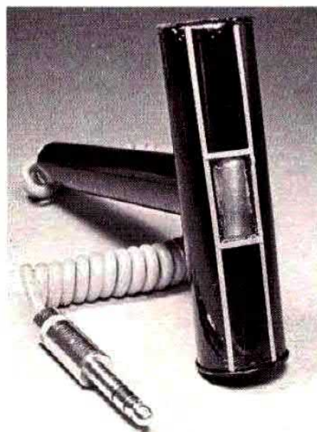
Il trasformatore (a sinistra), la sonda (in basso), la basetta (a destra). Nel prototipo sono previsti anche un jack per l'ascolto in cuffia e un jack per l'alimentazione esterna per uso in laboratorio.
