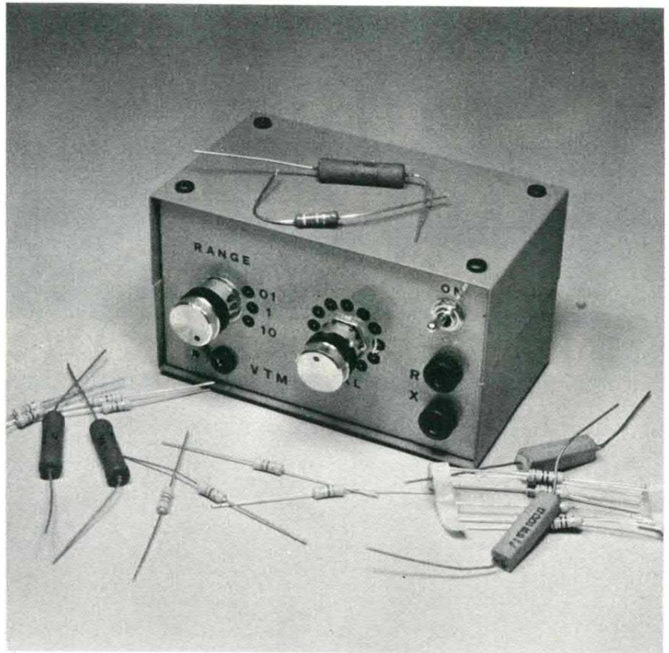
zioni di taratura e lo strumento è pronto ad entrare in funzione. Chi incontrasse invece difficoltà nel reperire queste resistenze può utilizzare per R2 ed R6 quelle comuni al 5% di tolleranza e sostituire R1, R3, R7 ed R8 con dei trimmer potenziometrici.
