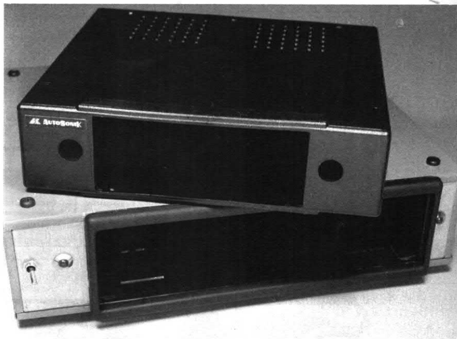
L'apparecchio completo. Per la meccanica si è usato un contenitore Ganzzerli Mini-box ed un kit per autoradio estraibili Autosonik acquistato presso la Autostereo (P.le Massari) di Milano.
