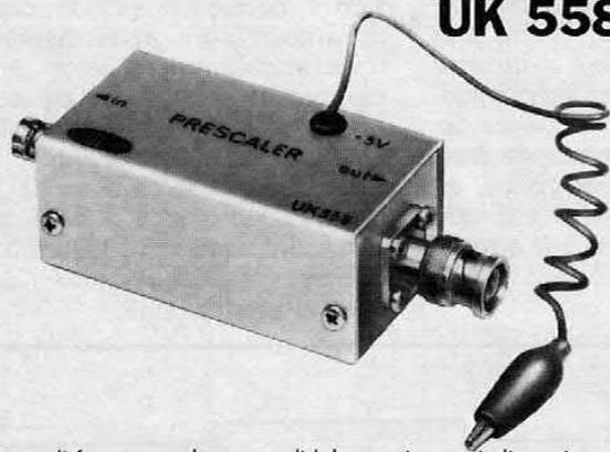
Un divisore di frequenza che agisce da interfaccia tra una sorgente di segnale UHF ed un frequenzimetro digitale VHF. Indispensabile per una precisa misura della frequenza nelle emittenti radiotelevisive, per usi
