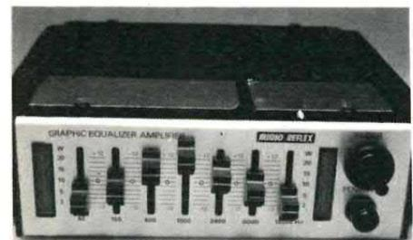
**AMPLI-EQUALIZZATORE 25+25 W**
