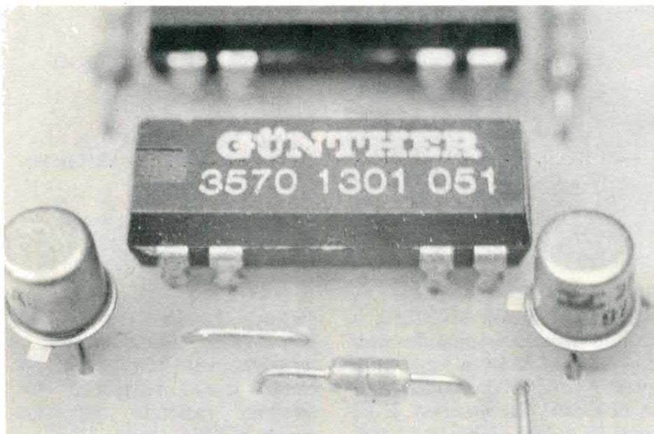
*Uno dei piccolissimi relè ed i transistor per il corretto pilotaggio delle bobine. In primo piano, il diodo di protezione di uno dei transistor.*
