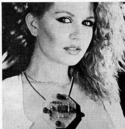
*Un primo circuito: solo un integrato, il 555, e con lo schema utilizzato quattro led si accenderanno alternativamente a due a due. Per un effetto... più forte, i led sono stati montati incrociati, cioè sulla punta di una immaginaria croce a quattro bracci. La basetta stampata, cod. 30-6, costa solo 1.500 lire.*
