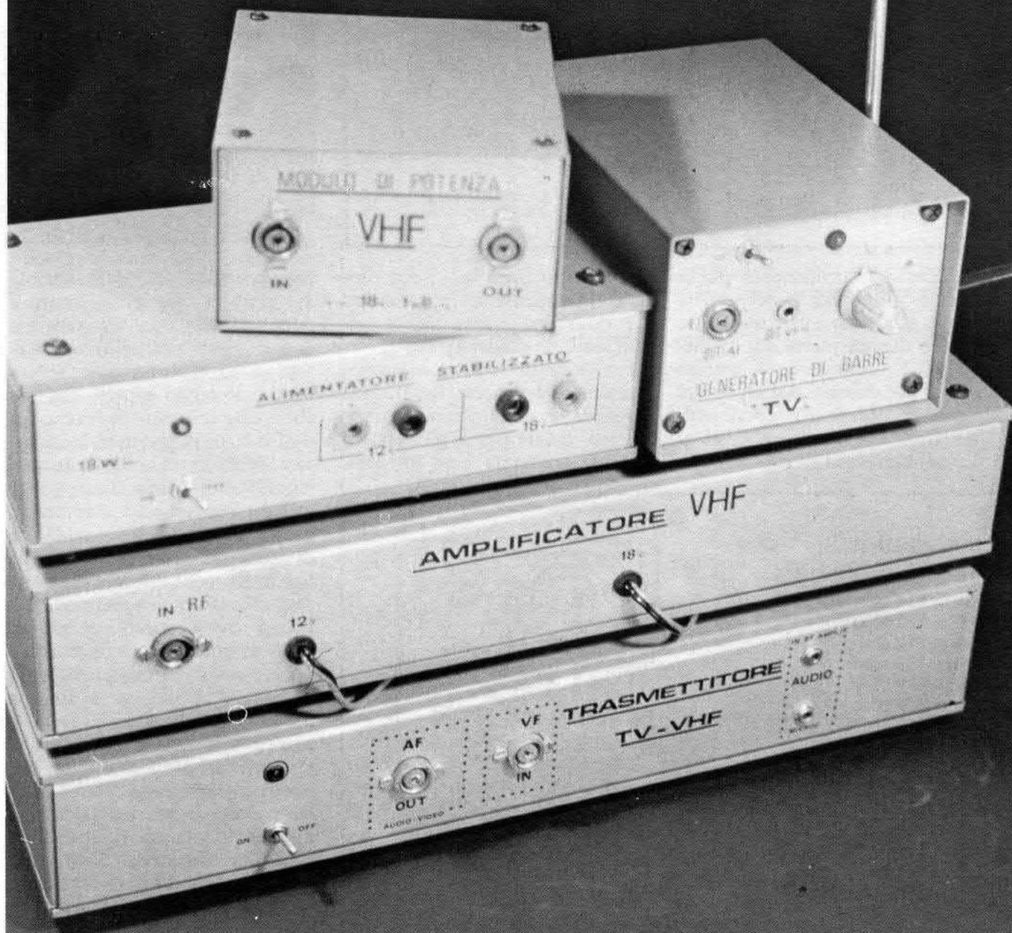
**I**l mese scorso abbiamo presentato gli stadi eccitatori e modulatore audio-video necessari per la costruzione della stazione televisiva. Per consentire ora una perfetta taratura di tali dispositivi e per disporre di un segnale video da irradiare senza necessariamente acquistare una telecamera, proponiamo la costruzione di un generatore di barre che, oltre a servire come generatore video per la stazione TV, è anche un ottimo strumento di laboratorio per la messa a punto di televisori guasti.
