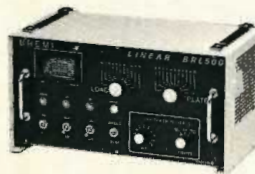
BRL 500 amplificatore lineare Potenza d'ingresso 0,2-10 W AM. Potenza di uscita 500 W AM. Tensione di alimentazione 220 V a.c.
