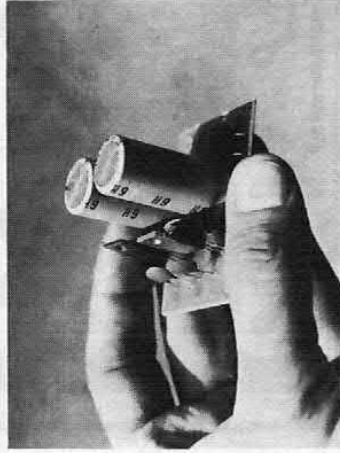
L'alimentatore fornisce una tensione duale di 8+8 volt. Componenti: C1, C4 = 1.000 uF 16 V, C2, C3, C5, C6 = 100 KpF, D1-D4 = 1N4001, U1 = 7808, U2 = 7908, TF1 = 220/12+12 0,5 A.
