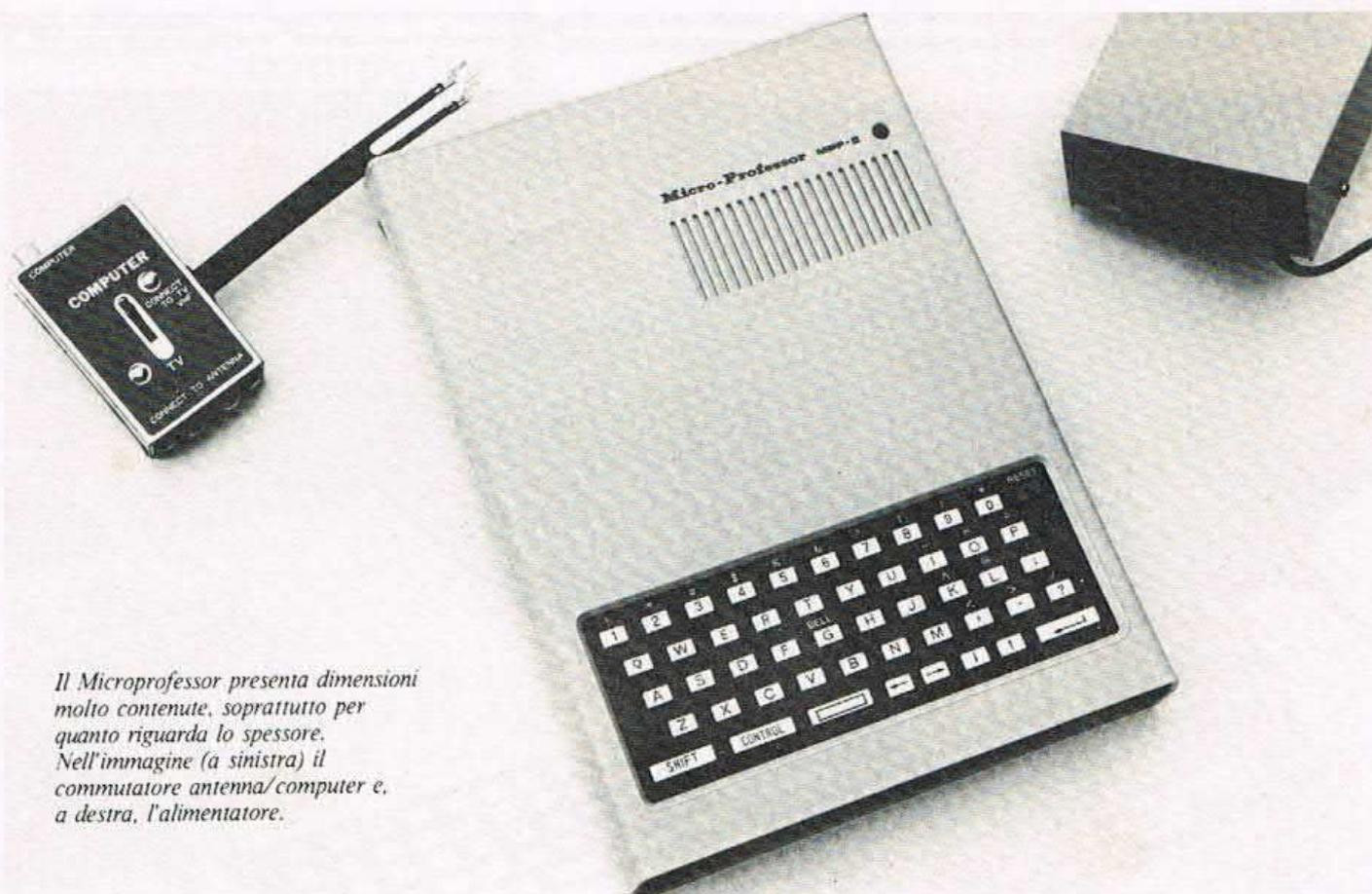
*Il Microprofessor presenta dimensioni molto contenute, soprattutto per quanto riguarda lo spessore. Nell'immagine (a sinistra) il commutatore antenna/computer e, a destra, l'alimentatore.*
