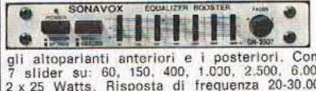
Tasto e spia luminosa per l'accensione. Bypass. Tasto per l'esclusione dell'equalizzatore. Bilanciamento fra gli altoparlanti anteriori e i posteriori. Comandi di controllo frequenza a 7 slider su: 60, 150, 400, 1.000, 2.500, 6.000, 15.000 Hz. Potenza d'uscita 2 x 25 Watts. Risposta di frequenza 20-30.000 Hz. Impedenza d'uscita 4-8 Ohm. Alimentazione 12 Vc.c. negativo a massa. Dimensioni 160 x 25 x 126 mm. **PREZZO L. 68.000**
