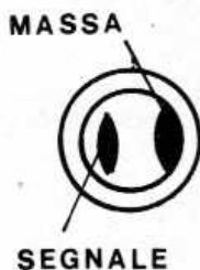
La capsula microfonica (vista dal retro) e i relativi collegamenti.
