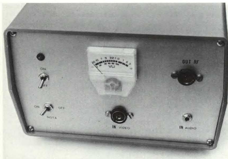
Sul pannello frontale dell'eccitatore trovano posto tutti i controlli nonché le entrate e le uscite.
