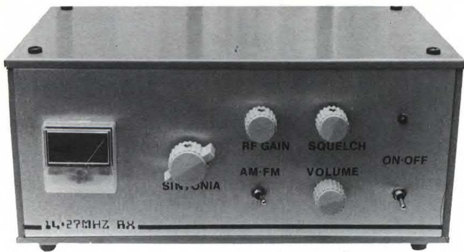
Il ricevitore è stato alloggiato all'interno di un contenitore metallico Ganzerli della serie mini-box. Sul frontale trovano posto tutti i controlli, sul retro è ovviamente presente il bocchettone d'antenna.
