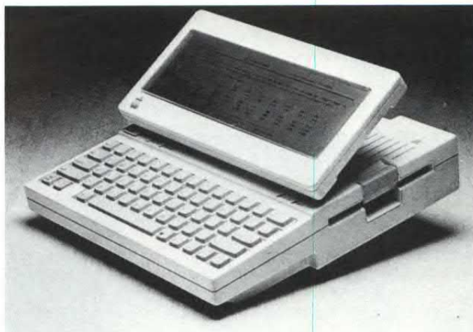
Il visore portatile a pannello piatto dell'Apple IIc: cristalli liquidi, schermo 80 colonne per 24 righe. Piccolo, sottile, leggero.
