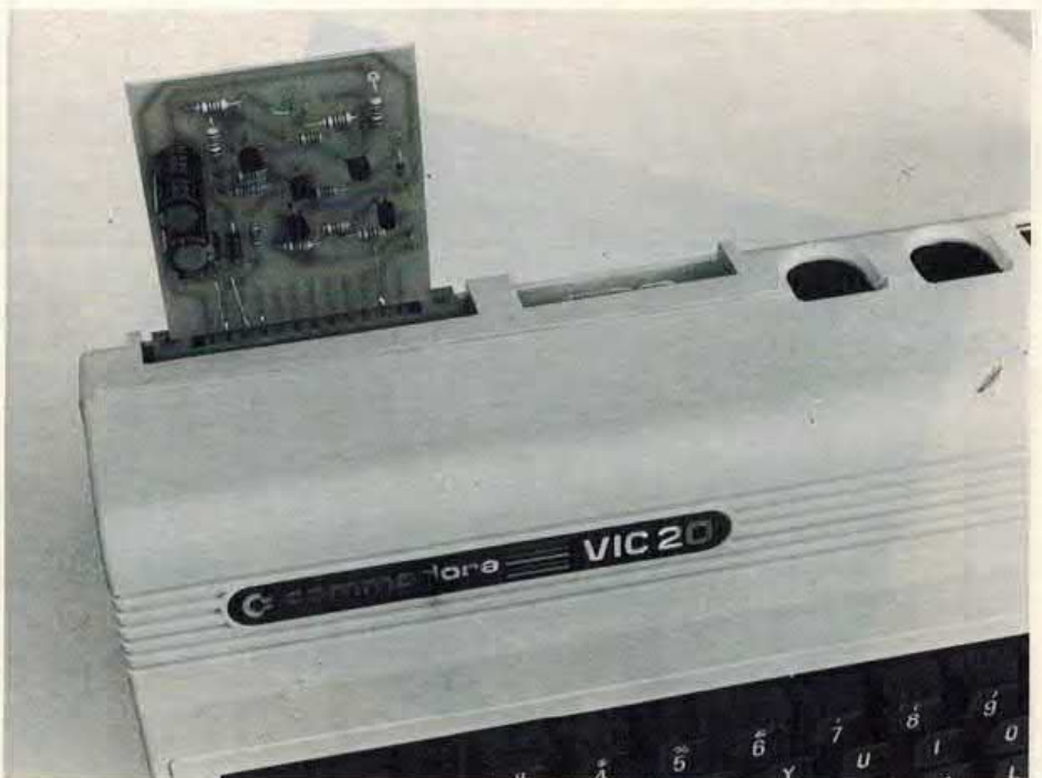
L'interfaccia va collegata alla user port del VIC come si vede in fotografia. Per il collegamento al modem bisogna utilizzare tre conduttori (in, out e massa).
