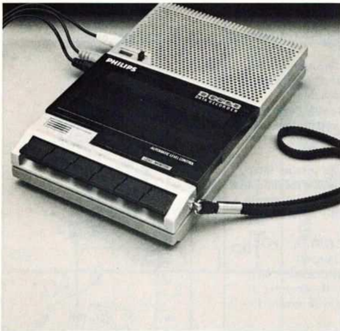
Nell'immagine il registratore per dati Philips, una buona soluzione per fare una copia del programma prima di introdurre qualsivoglia sistema di protezione.
