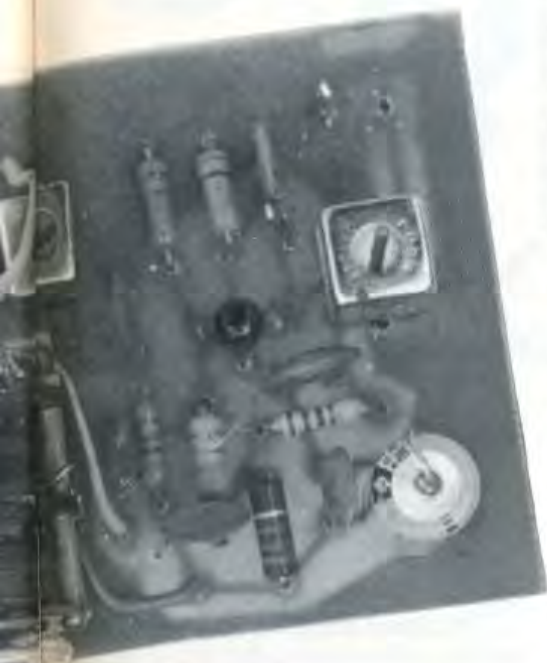
Il commutatore rotativo (4 vie 4 posizioni) consente di selezionare le varie frequenze necessarie per la ricezione dei segnali USB, LSB e CW.
