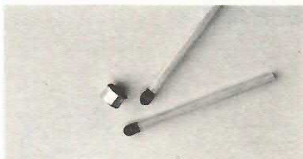
La capsula ceramica preamplificata è molto piccola: diametro appena 5 millimetri.
