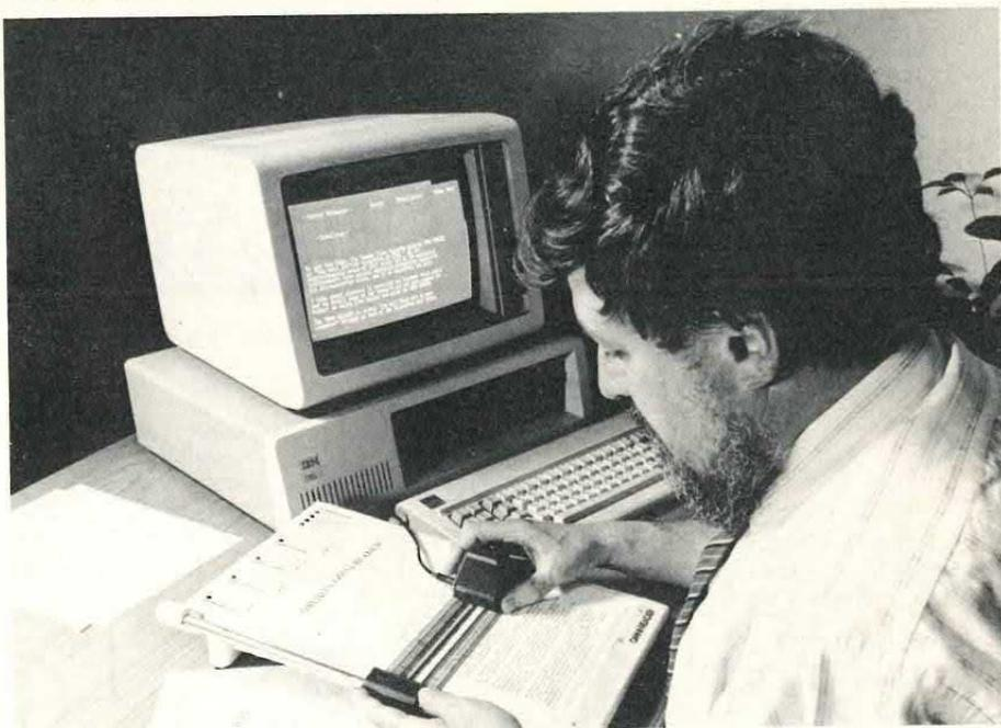
Questo è Omni-Reader, un apparecchio lettore di caratteri che trasferisce testi o dati alfanumerici da una pagina dattiloscritta ad un computer, ad una velocità di due o tre secondi per linea — velocità più che doppia rispetto a quella di un'esperto nell'uso di un «word processor», elaboratore della parola.
