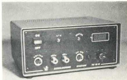
Stazioni di saldatura (in alto) e di dissaldatura (qui sopra). La temperatura si legge sul display. Sono prodotti Videobit.
