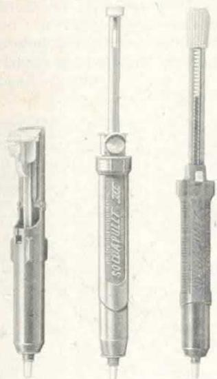
Dissaldatori ERSA: per recuperare i componenti e per rifare meglio una saldatura... impossibile.
