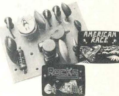
Un piccolo circuito per rimediare ad uno dei difetti più fastidiosi dello Spectrum: la mancanza del segnale audio sul TV. Di facile installazione all'interno dello Spectrum (solo tre fili da collegare). Viene fornito già montato e tarato.
