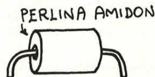
J1 = J2 = 1 perlina Amidon con filo passante di rame nudo del diametro di 0,8 millimetri.
