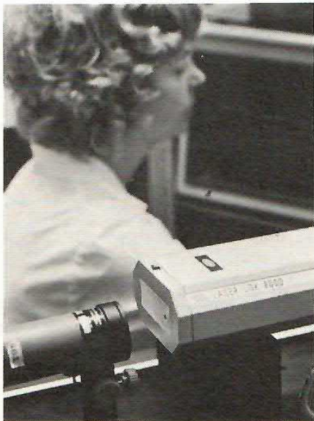
Il laser LG 8000, Siemens, a CO 2 : Un vero e proprio cannello da taglio!
