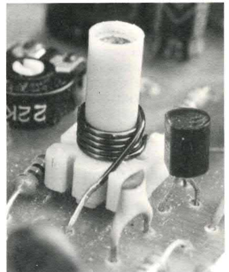
Sulla basetta principale: la bobina L3 (a sinistra), l'integrato U2 (qui sotto), la bobina L1 (a destra).
