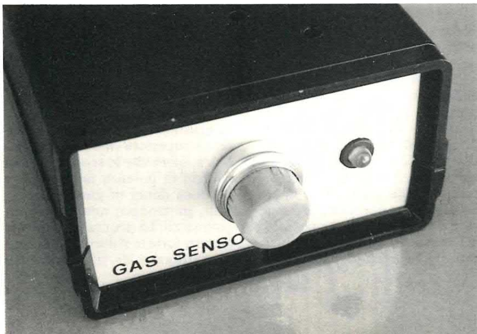
La sonda rivelatrice deve essere montata all'esterno del contenitore.
