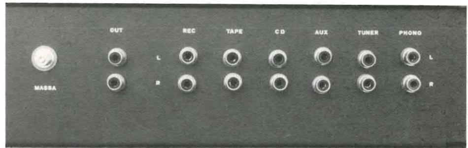
**Il pannello posteriore: isolare le boccole d'uscita dalla carcassa del mobile. Utilizzare per quanto possibile fili schermati per evitare noise fastidiosi.**
