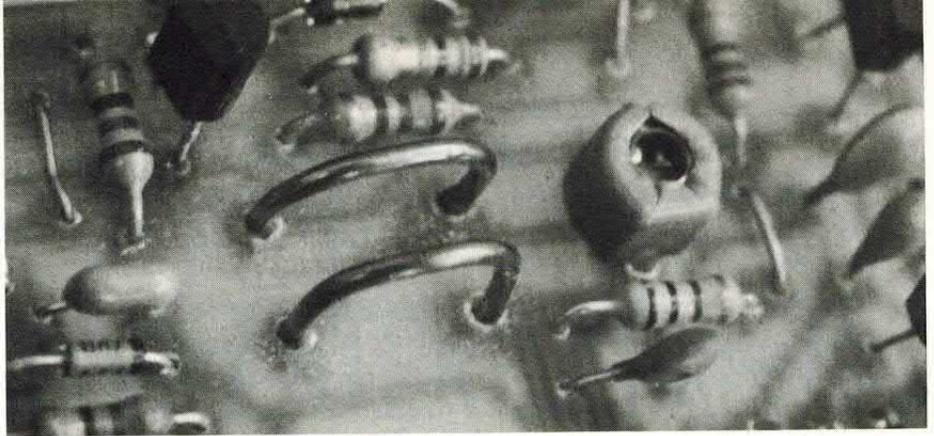
Particolare delle due bobine (quasi dei ponticelli) che devono essere perfettamente uguali tra loro. Usare filo di rame smaltato diametro 0,8-1 mm.
