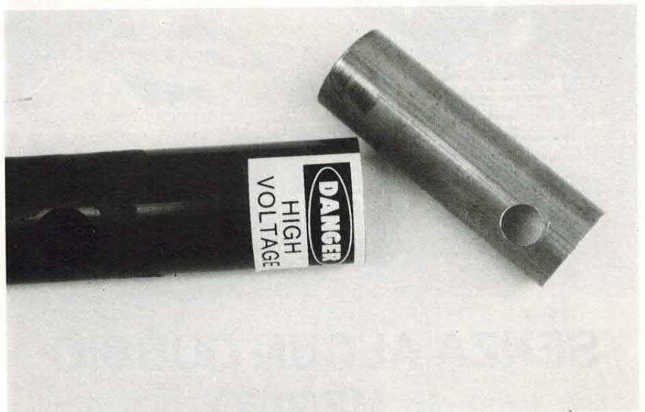
Particolare del contenitore utilizzato nel nostro prototipo. Il cilindro metallico andrà infilato nel manico isolante. I fori che si vedono servono (vedi disegni nelle pagine seguenti) per il neon di segnalazione e per l'interruttore pulsante.
