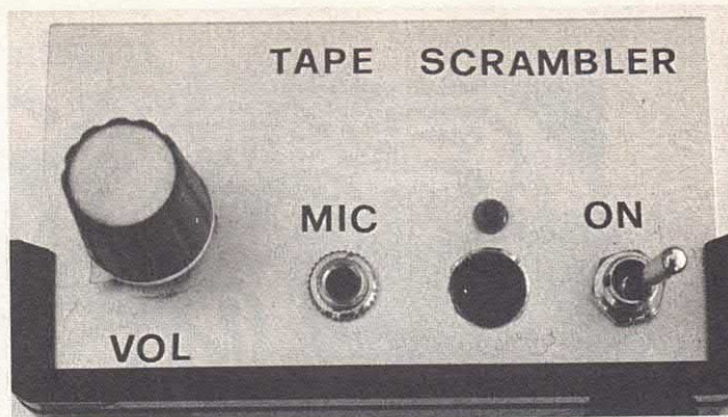
Piano di foratura del pannello anteriore. Il contenitore è un Teko mod. 10002.
