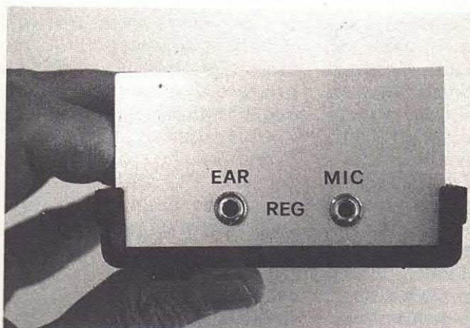
Piano di foratura del pannello posteriore sul quale è previsto il fissaggio di due prese jack da 3,5 mm.
