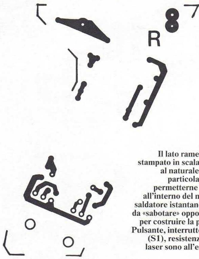
Il lato rame del circuito stampato in scala 1:1, ovvero al naturale. La sagoma particolare dovrebbe permetterne l'inserzione all'interno del manico di un saldatore istantaneo a pistola, da «sabotare» opportunamente per costruire la pistola laser. Pulsante, interruttore a levetta (S1), resistenza R2 e tubo laser sono all'esterno dello stampato.
